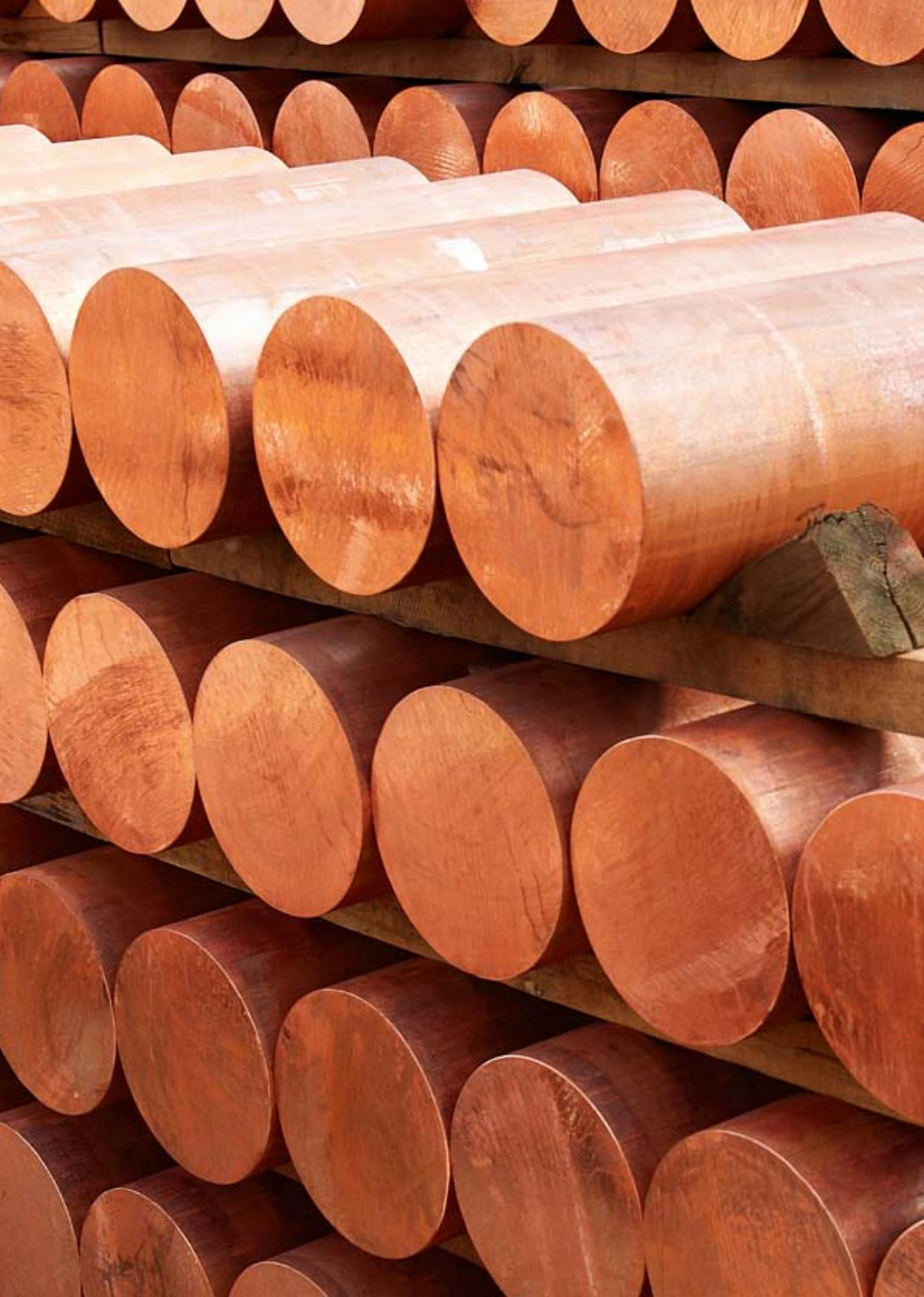
Bis zu 30.000 kg kann ein Stranggussformat aus Kupfer wiegen. Zu schwer für den Transport auf der Straße. Deshalb werden die Stranggussformate auf der Schiene zum weiterverarbeitenden Kunden transportiert.
